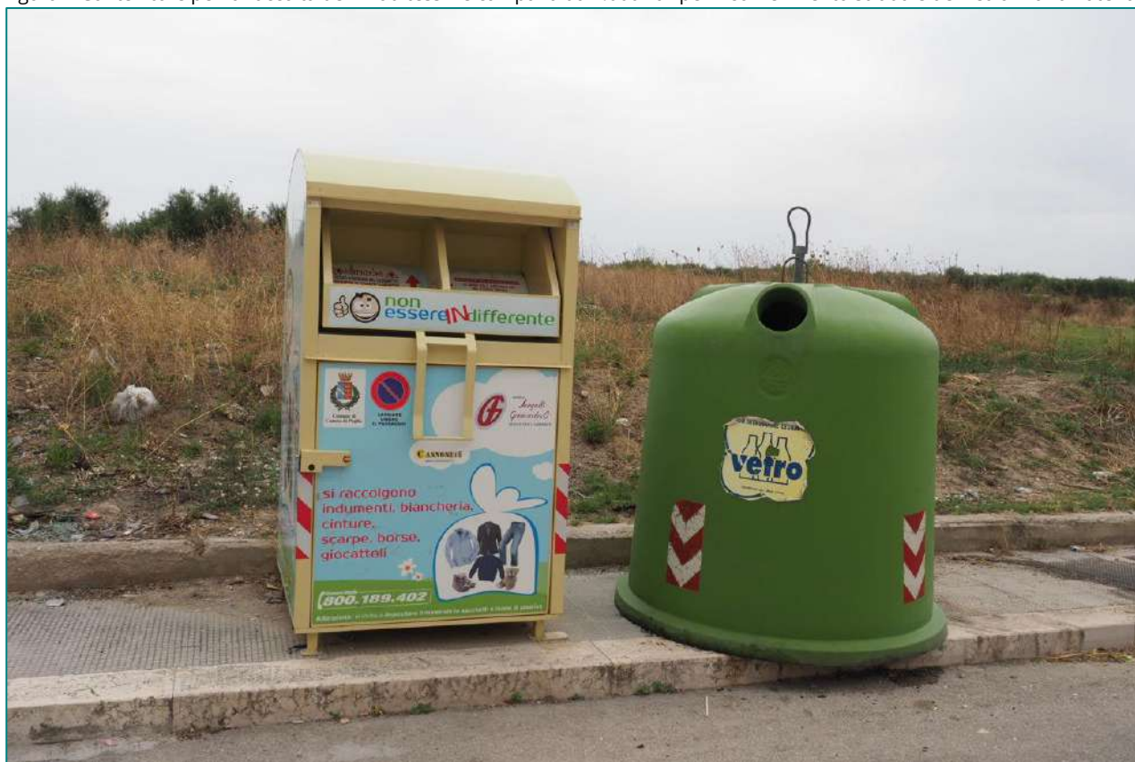
Figura 2 Contenitore per la raccolta dei rifiuti tessili e campana da 2.000 litri per il conferimento stradale del vetro monomateriale
