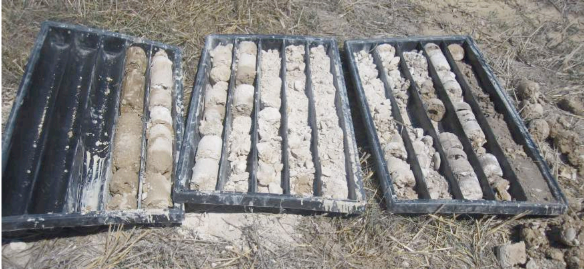
Foto N°3 Particolare carotaggio S1 tra 0.0 e 12 m.
